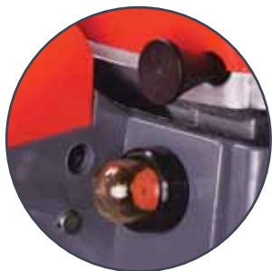
Система PRIMER – быстрый запуск непрогретого двигателя
