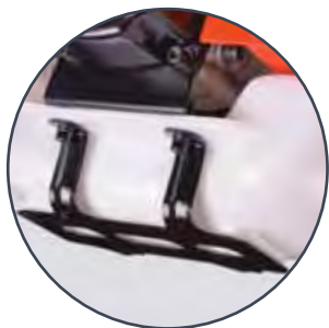
Металлическая защита топливного бака
